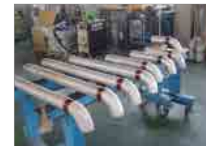
●浸透深傷検査
